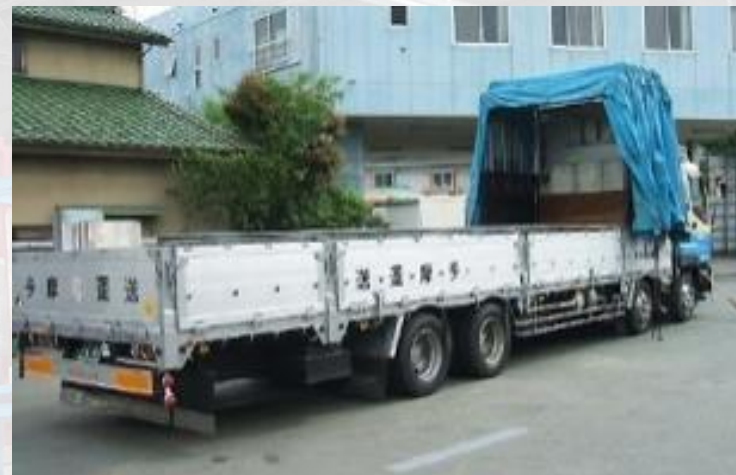
15トン低床ジャバラ総輪エアサス車 シート掛けが出来ない荷物には大変便利です。
