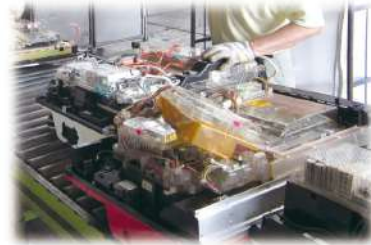
解体中の産業廃棄物
